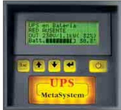
Para los usuarios expertos se pueden programar las modalidades de aprovechamiento de la energía de backup sobre la base de los umbrales de tensión de batería, de tiempos de funcionamiento prefijados o sobre la base del Status Of Charge de las baterías.
