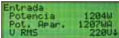
El submenú de la sección de ENTRADA proporciona al usuario todos los datos sobre el funcionamiento UPS sin necesidad de conectarse a un software.
